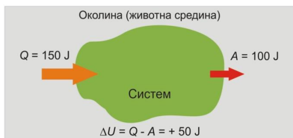
а) Што се више топлоте додаје у систем, систем остварује рад: унутрашња енергија система расте.
